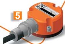
**5** Датчик положения крышки ДПК-1 взрывозащищенный 1Ex db IIB T4 Gb служит для контроля положения крышки люка (закрыто/открыто) и крышки сливного ящика автоцистерны.
