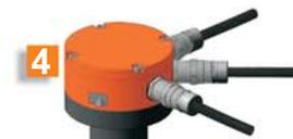
**4** Датчик уровня транспортный взрывозащищенный 1Ex db IIB T4 Gb служит для контроля полноты налива жидкости в отсеке автоцистерны относительно планки и контроля слива жидкости из автоцистерны, измеряет температуру жидкости в отсеке автоцистерны, защищает отсек автоцистерны от перелива (по интерфейсу 5-wire) при нижнем наливе.
