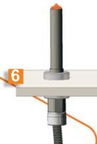
**6** Датчик ДЛОК-Н2 наличия жидкости в отсеке и сливной трубе автоцистерны, взрывозащищенный Ga/Gb Ex ia/ma IIBT4, предназначен для контроля наличия нефтепродуктов в автоцистерне (наличие/отсутствие).
