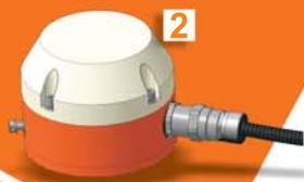
**2** Антенна ANT GPS/GLONASS, GSM, Wi-Fi взрывозащищенная 1Ex db IIB T4 Gb обеспечивает приём и передачу данных в диапазоне частот системы GPS/GLONASS и GSM, а так же обмен данными между планшетом и монитором TC-ТГ по каналу Wi-Fi.
