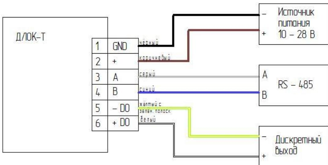
Рисунок 28. Схема подключения датчика температуры ДЛОК-Т
