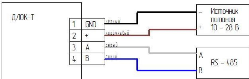
Рисунок 4. Схема подключения датчика температуры ДЛОК-Т к ПК
