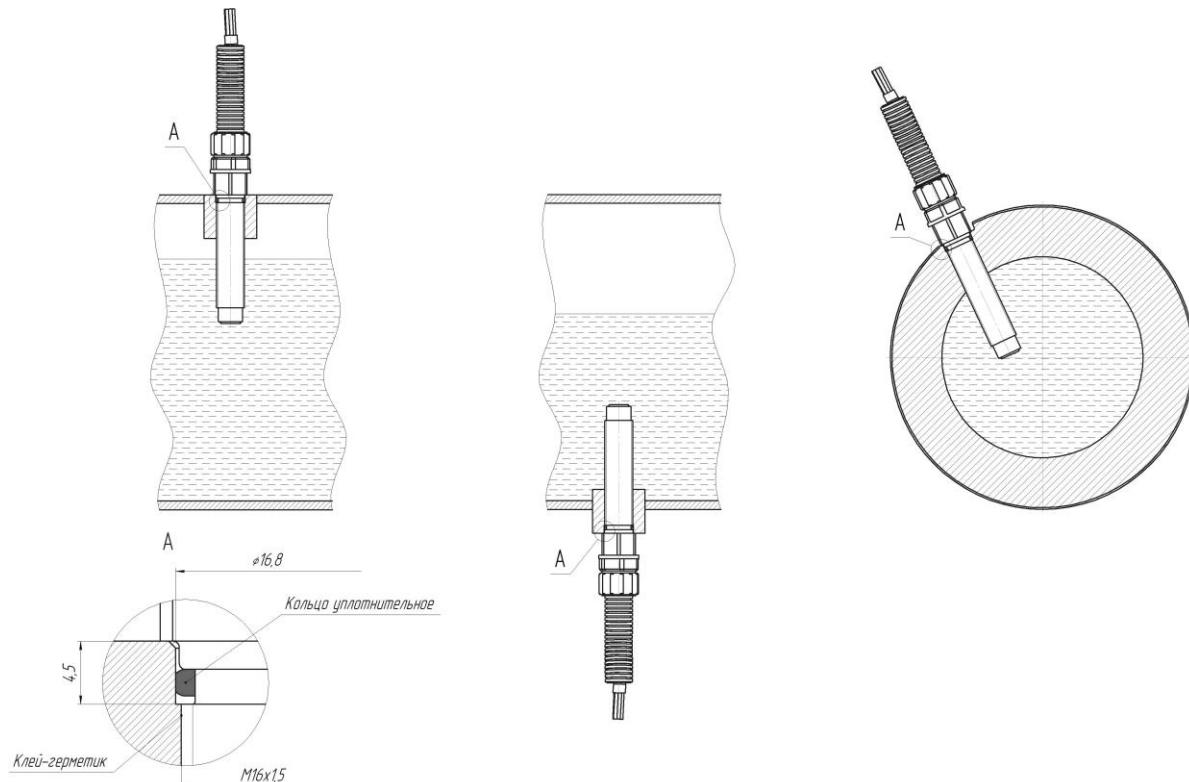
Рисунок 2. Установка датчика температуры
