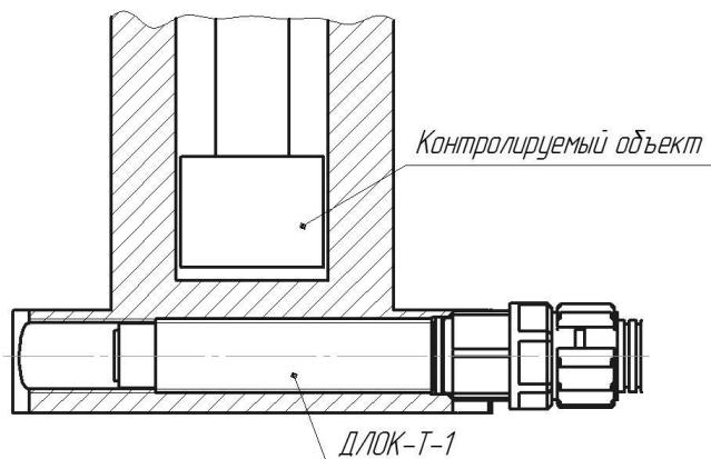
Рисунок 3. Пример установки ДЛОК-Т-1 (модификация с датчиком положения)
